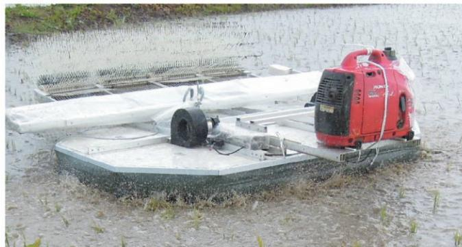
○試験走行の様子。水しぶきはホバークラフトの高圧空気によるもの。
